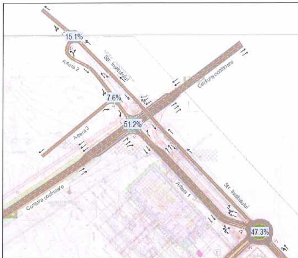
Fig. 12 – Intersecția Centura ocolitoare Brașov – Str. Institutului (schema de principiu a fluxurilor de circulație)
